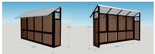
ภาพที่ 14 แบบร่างชุดแผงกันแดด Passive & Active Mixed Cooling System 3 มิติที่สมบูรณ์
