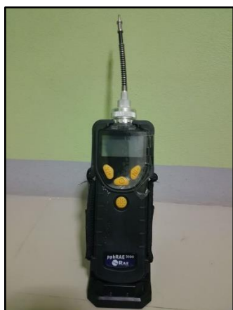
ภาพที่ 1 เครื่องตรวจวัดสารอินทรีย์ระเหยง่าย ยี่ห้อ RAE SYSTEMS รุ่น ppbRAE 3000
