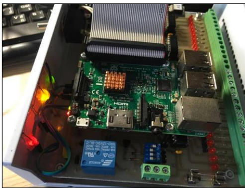
ภาพที่ 4 บอร์ดควบคุมที่สร้างขึ้นจากวงจรอินเทอร์เฟซที่ แสดงในภาพที่ 3 หมายเลข 1
