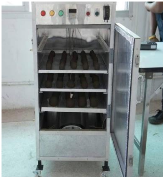
ภาพที่ 5 ตู้ทดสอบลดความชื้นในแม่พิมพ์เครื่องทองเหลือง
